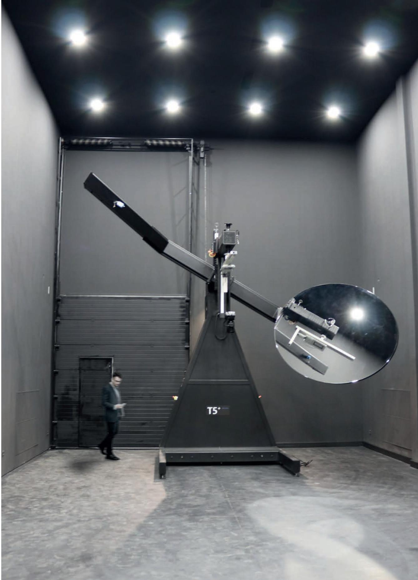
A Exporlux possui um dos mais avançados laboratórios luminotécnicos com a aquisição do T5+ - Goniophoto - spectrometer.
